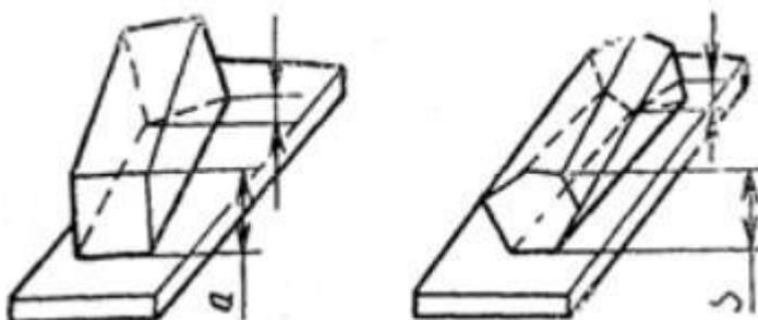
2.10. Радиус закругления продольных ребер тянутых прутков квадратного и шестигранного сечения не должен превышать: 0,5 мм — для размеров до 25 мм включ.; 1,0 мм — для размеров свыше 25 мм.
